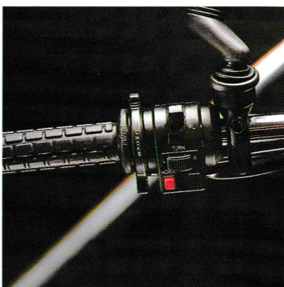
Der Drehchoke am Handgriff – praxisgerecht, wie alle neuen Bedienungselemente (Bild unten).
