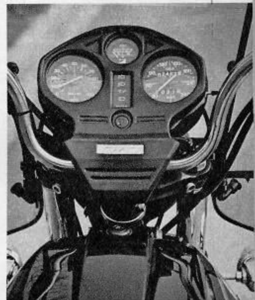
Il cruscotto di forma semi-ellittica, comprende anche il voltmetro. Sulla sinistra, appena sopra al tappo della forcella, è sistemato il deviatore dell'accensione simultanea dei quattro indicatori di direzione per l'emergenza. Sulla sommità dello stelo destro della forcella, c'è la valvola per l'aria della sospensione anteriore.
