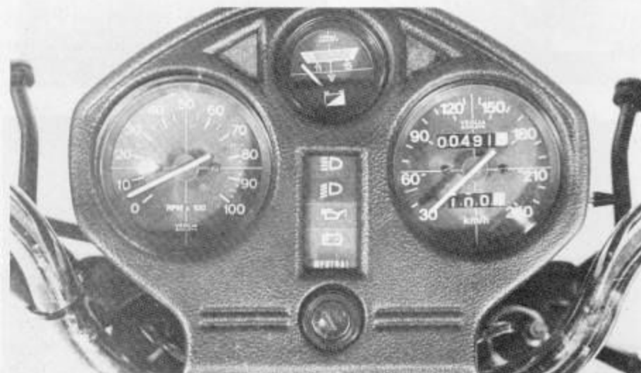
La console, plus simple et plus sobre, propose une instrumentation suffisante. En haut, le voltmètre entouré de témoins de clignotants. Entre les compteurs, témoins de phare, code, huile et charge. Totalisateur journalier sur le tachymètre.
