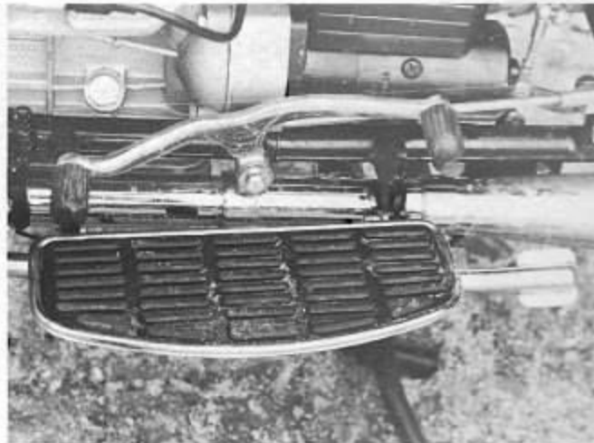
Het hak-teen-pedaal voor de bediening van de versnellingsbak
