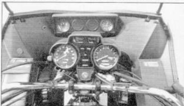
**Komplett: Gold Wing mit Tankuhr, Uhr und Voltmeter**
