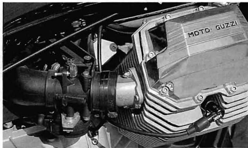
Wohltäter: Die Einspritzanlage macht Schluß mit schwergängigen Gasgriffen – kein Vergaser, keine Rückholfeder
