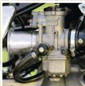
Kraftkur: Rundschieber-vergaser mit Beschleunigerpumpe anstelle der serienmäßigen eckigen Dell'Ortos-
