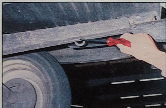
**Korrosion:** Bei alten Modellen gibt es am Falz des Heckrahmens schon mal größere Rostprobleme
