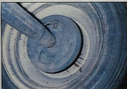
**Bremse hinten:** Die Beläge halten bis zu 80 000 km. Hier tritt bereits Bremsflüssigkeit aus – ab in die Werkstatt
