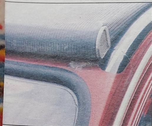
**Rolldach:** Auch hier auf Rost achten. Flecken innen verraten undichte Stellen. Eine neue PVC-Haut kostet 299 Mark
