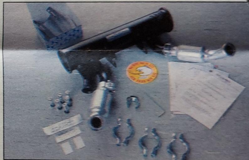
Die ASU-Werkstatt braucht für den Einbau etwa eine Stunde. Dann ist die Ente endlich stubenrein. Der Werkstattmeister bescheinigt den ordnungsgemäßen Einbau. Fertig
