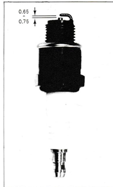
Abb. 46 – Zündkerze – Elektrodenabstand
